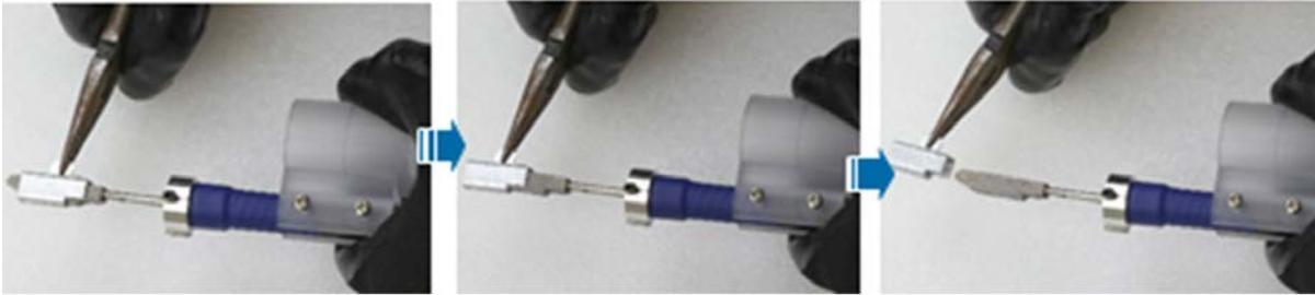
7. 断开工具连接的电源，等工具冷却后将透明光缆穿过铝合金部件，将铝合金部件安装回去。
